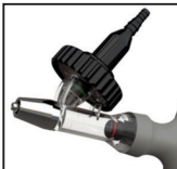
fig.1b: Uniquement pour bouteilles filetées: Tenez la HSW ECO-MATIC® avec le pointeau aspirant en bas, et vissez la bouteille de filet sur l'adaptateur. Le démontage s'effectue en ordre renversé.
