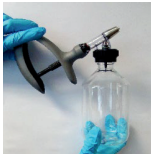
fig.1b: Uniquement pour bouteilles filetées: Tenez la HSW ECO-MATIC® avec le pointeau aspirant en bas, et vissez la bouteille de filet sur l'adaptateur. Le démontage s'effectue en ordre renversé.
