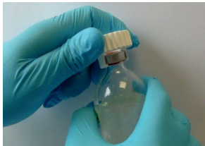
fig.1a: Choisissez l'adaptateur correspondant pour la bouteille correspondante. Introduisez la bouteille dans l'adaptateur universel.
